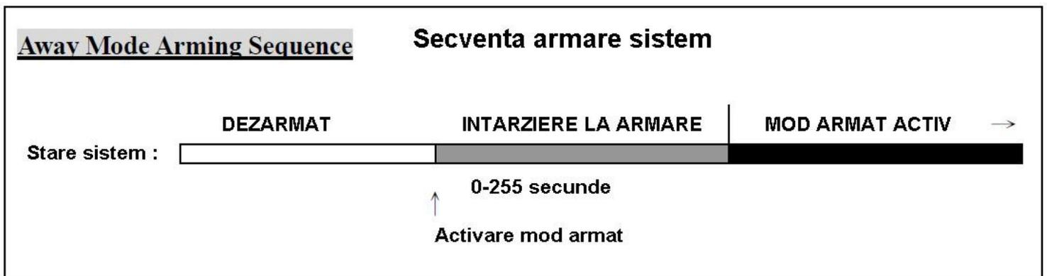
La armare, daca unul din senzori este “declansat” (de exemplu un contact magnetic uitat deschis) avertizeaza vocal si visual pe ecran si insereaza automat 20 de secunde intarziere la armare daca nu s-a definit deja alt timp.
